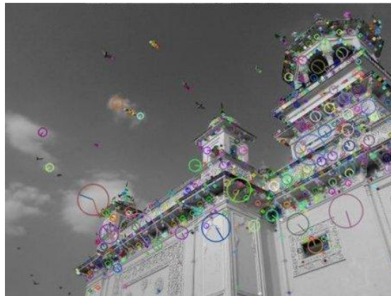
Slika 2. Skup ključnih tačaka detektovanih uz pomoć SIFT algoritma
